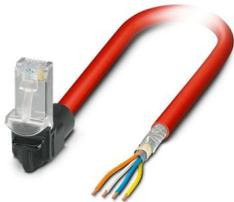
Câble de jonction, indice de protection: IP20, longueur de câble: 5 m, nombre de pôles: 4, 100 Mbit/s, CAT5, matériau: PP, type de raccordement: Raccordement Pierce, sortie du câble: en bas, PROFINET
