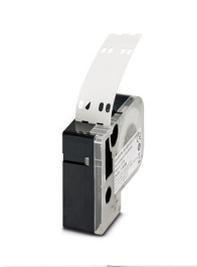
Repères pour câble, Rouleau, blanc/noir, vierge, repérable avec : THERMOMARK GO, type de montage: Montage de serre-câbles, plage de diamètre de câble: 6 ... 115 mm, surface utile: 40 x 8,5 mm, Nombre d'étiquettes: 50
