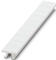
Ruban de repérage ZB, à commander : par bandes, blanc, impression selon les indications du client, type de montage: encliquetage dans la rainure de repérage élevée, pour bloc de jonction au pas de : 8,2 mm, surface utile: 10,5 x 8,15 mm, Nombre d'étiquettes: 10
