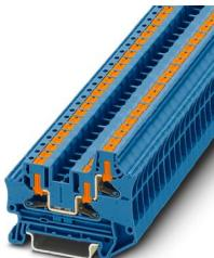
Blocs de jonction simple, tension nominale: 1000 V, intensité nominale: 41 A, nombre de connexions: 3, nombre de pôles: 1, type de raccordement: Raccordement Push-in, Section de référence: 6 mm<sup>2</sup>, section : 0,5 mm<sup>2</sup> - 10 mm<sup>2</sup>, type de montage: NS 35/7,5, NS 35/15, coloris: bleu
