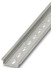
Profilé percé, Conditionnement par 25 unités (50 m), selon EN 60715, matériau: Acier, galvanisé, traité par passivation couche épaisse, Profil standard, coloris: argent
