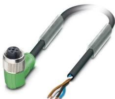
Câble pour capteurs/actionneurs, 4-pôles exempt d'halogène, extrémité libre, sur Connecteur femelle coudé M12, détrompage: A, longueur de câble: 5 m
