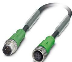
Câble pour capteurs/actionneurs, 4-pôles exempt d'halogène, connecteur mâle droit M12, détrompage: A, sur Connecteur femelle droit M12, détrompage: A, longueur de câble: 5 m
