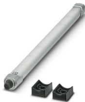
Lampe LED pour machine, 24 V DC, angle de rayonnement: 89 °/97 °, longueur: 335 mm, diamètre: 25 mm, indice de protection: IP54, pivotant
