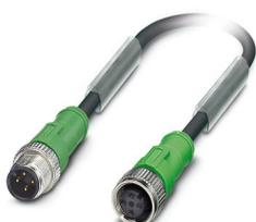
Câble pour capteurs/actionneurs, 4-pôles exempt d'halogène, connecteur mâle droit M12, détrompage: A, câblé avec déconnecté, sur Connecteur femelle droit M12, détrompage: A, longueur de câble: 3 m
