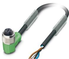
Câble pour capteurs/actionneurs, 4-pôles exempt d'halogène, extrémité libre, sur Connecteur femelle coudé M12, détrompage: A, longueur de câble: 1,5 m
