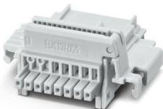
Connecteurs sur profilé, coloris: gris clair, intensité nominale: 6 A, 4 A (contacts parallèles) (Contacts série), tension de référence (III/2): 32 V, nombre de pôles: 8, pas: 2,54 mm, montage: Montage sur profilé, verrouillage: sans, type de fixation: sans, type de conditionnement: emballé dans un carton, Article avec contacts dorés, connecteur de bus pour le raccordement de boîtiers électroniques, 7 contacts parallèles/1 contact série
