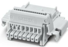
Connecteurs sur profilé, coloris: gris clair, intensité nominale: 6 A, 4 A (contacts parallèles) (Contacts série), tension de référence (III/2): 32 V, nombre de pôles: 8, pas: 2,54 mm, montage: Montage sur profilé, verrouillage: sans, type de fixation: sans, type de conditionnement: emballé dans un carton, Article avec contacts dorés, connecteur de bus pour le raccordement de boîtiers électroniques, 7 contacts parallèles/1 contact série
