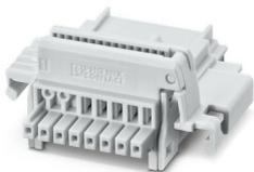
Connecteurs sur profilé, coloris: gris clair, intensité nominale: 6 A, 4 A (contacts parallèles) (Contacts série), tension de référence (III/2): 32 V, nombre de pôles: 8, pas: 2,54 mm, montage: Montage sur profilé, verrouillage: sans, type de fixation: sans, type de conditionnement: emballé dans un carton, Article avec contacts dorés, connecteur de bus pour le raccordement de boîtiers électroniques, 4 contacts parallèles/4 contacts série
