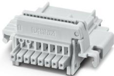
Connecteurs sur profilé, coloris: gris clair, intensité nominale: 6 A (contacts parallèles), tension de référence (III/2): 32 V, nombre de pôles: 8, pas: 2,54 mm, montage: Montage sur profilé, verrouillage: sans, type de fixation: sans, type de conditionnement: emballé dans un carton, Article avec contacts dorés, connecteur de bus pour le raccordement de boîtiers électroniques, 8 contacts parallèles
