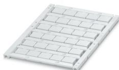
Repères pour blocs de jonction, à commander : sous forme de planche, blanc, impression selon les indications du client, type de montage: encliquetage dans la rainure de repérage élevée, pour bloc de jonction au pas de : 12 mm, surface utile: 10,8 x 9,6 mm, Nombre d'étiquettes: 30
