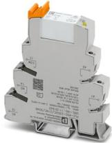
PLC-INTERFACE contre les tensions ou les courants perturbateurs côté commande. Comprenant un bloc de jonction de base PLC-BSC-230UC/21HC/SO46 à raccordement vissé, et un relais miniature enfichable à contact de puissance jusqu'à 10 A, 1 contact inverseur, tension d'entrée 230 V AC
