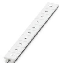
Ruban de repérage ZB, Rubans, blanc, repéré, repérable avec : CMS-P1-PLOTTER, impression longitudinale: numérotation continue 1 ... 10, 11 ... 20, etc. jusqu'à 91 ... 100, type de montage: encliquetage, pour bloc de jonction au pas de : 10,2 mm, surface utile: 10,15 x 10,5 mm, Nombre d'étiquettes: 10
