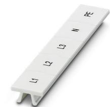
Ruban de repérage ZB, Rubans, blanc, repéré, impression longitudinale: L1, L2, L3, N, PE, type de montage: encliquetage, pour bloc de jonction au pas de : 12,2 mm, surface utile: 10,5 x 12,15 mm, Nombre d'étiquettes: 5
