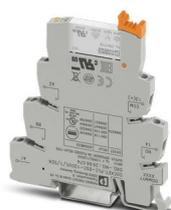
PLC-INTERFACE contre les tensions ou les courants perturbateurs côté commande. Comprendant un bloc de jonction de base PLC-BSC-230UC/ 1/SEN/SO46 à raccordement vissé et un relais miniature enfichable à contact doré multicouches, 1 contact NO, tension d'entrée 230 V AC
