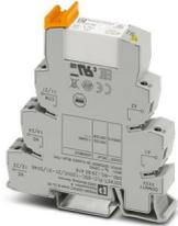
PLC-INTERFACE contre les tensions ou les courants perturbateurs côté commande. Comprendant un bloc de jonction de base PLC-BSC-120UC/21-21/SO46 à raccordement vissé, et un relais miniature enfichable à contact de puissance jusqu'à 2x 8 A, 2 contacts inverseurs, tension d'entrée 120 V AC
