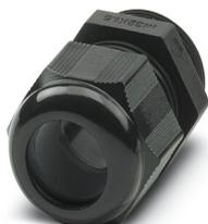
Presse-étoupe, matériau du raccordement vissé: PA, diamètre extérieur du câble 15 mm ... 21 mm, blindage: non, filetage de raccordement: M32 x 1,5, coloris: noir foncé RAL 9005
