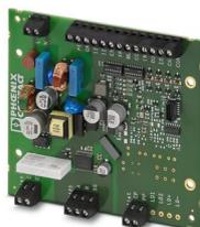
L'automate de charge EV-CC-AC1-M3-CC-SER-PCB sous forme de circuit imprimé sert à la recharge des véhicules électriques sur le réseau à courant alternatif triphasé selon la norme CEI 61851-1, Mode 3. Optimisé pour les stations de recharge avec un connecteur de charge pour véhicule, monté en fixe. Toutes les fonctions de recharge et de vastes réglages de configuration sont déjà intégrés.
