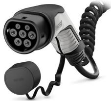
CHARX connect comfort, Câble de charge AC, avec connecteur de charge côté véhicule et extrémité de câble libre, pour charger en courant alternatif (AC) des véhicules électriques (EV) à prise côté véhicule de type 2, avec cache de protection, Type 2, CEI 62196-2, 32 A / 480 V (AC), boîtiers: noir, gris, Logo PHOENIX CONTACT, câble: 5 m, noir, hélicoïdal
