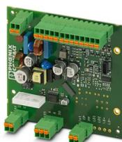
L'automate de charge EV-CC-AC1-M3-CC-SER-PCB-MSTB sous forme de circuit imprimé sert à la recharge des véhicules électriques selon la norme CEI 61851-1, Mode 3 ; il est optimisé pour les stations de recharge avec un connecteur de charge pour véhicule, monté en fixe. Raccordement via un connecteur mâle pour C.I. sur l'embase.
