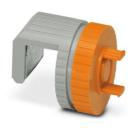
Le dispositif de maintien en option fournit une fixation en toute sécurité de la bobine de Rogowski sur des barres d'alimentation d'une épaisseur comprise entre 10 ... 15 mm. Lors de l'installation, le boîtier de la bobine coulisse sur la bride du dispositif de maintien et s'enclenche automatiquement.
