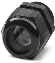
Presse-étoupe, matériau du raccordement vissé: PA, diamètre extérieur du câble 30 mm ... 36 mm, blindage: non, filetage de raccordement: M50 x 1,5, coloris: noir foncé RAL 9005
