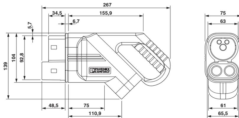
S'assurer que le connecteur de charge côté véhicule est enfiché pendant toute la durée de l'arrêt du chargement dans un support de connecteur de charge adapté, qui assure une protection minimale IP24 selon la norme CEI 61851-1. Pour fabriquer un tel support de connecteur de charge, utilisez les dimensions du connecteur de charge côté véhicule. Vous trouverez également des dimensions détaillées dans la zone des téléchargements.
