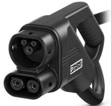
CHARX connect standard, Câble de charge DC, avec connecteur de charge côté véhicule et extrémité de câble libre, pour la charge en courant continu (DC) des véhicules électriques (VE), avec contact PP raccordé, avec cadre d'enchâssement échangeable, avec capteurs de température analogiques, CCS type 2, CEI 62196-3, 250 A / 1000 V (DC), Logo PHOENIX CONTACT, câble: 7 m, noir, droit
