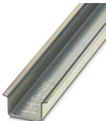
Profilé plein, Conditionnement par 25 unités (50 m), similaire à EN 60715, matériau: Acier, galvanisé, traité par passivation couche épaisse, Profil standard, coloris: argenté
