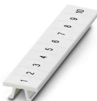
Ruban de repérage ZB, Rubans, blanc, repéré, impression longitudinale: numérotation continue 1 ... 10, 11 ... 20, etc. jusqu'à 491 ... 500, type de montage: encliquetage, pour bloc de jonction au pas de : 5,2 mm, surface utile: 5,15 x 10,5 mm, Nombre d'étiquettes: 10
