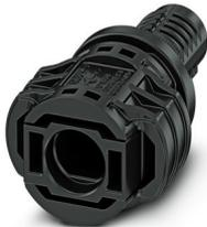
Embases paroi avant, Famille d'articles: Sunclix, matériau du boîtier: PPE, coloris: noir, nombre de pôles: 1, section de fil min.: 2,5 mm<sup>2</sup>, section de fil max.: 6 mm<sup>2</sup>, tension de référence: 1500 V DC, courant de référence: 38 A, Type de raccordement: Sertissage, Type de contact: Mâle
