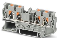
Blocs de jonction simple, tension nominale: 800 V, intensité nominale: 32 A, nombre de connexions: 4, type de raccordement: Raccordement Push-in, Section de référence: 4 mm<sup>2</sup>, section : 0,2 mm<sup>2</sup> - 6 mm<sup>2</sup>, type de montage: NS 35/7,5, NS 35/15, coloris: gris
