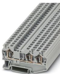
Blocs de jonction simple, tension nominale: 800 V, intensité nominale: 32 A, nombre de connexions: 3, type de raccordement: Raccordement à ressort, Section de référence: 4 mm<sup>2</sup>, section : 0,08 mm<sup>2</sup> - 6 mm<sup>2</sup>, type de montage: NS 35/7,5, NS 35/15, coloris: gris
