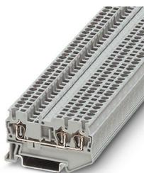
Blocs de jonction simple, tension nominale: 800 V, intensité nominale: 24 A, nombre de connexions: 3, type de raccordement: Raccordement à ressort, Section de référence: 2,5 mm<sup>2</sup>, section : 0,08 mm<sup>2</sup> - 4 mm<sup>2</sup>, type de montage: NS 35/7,5, NS 35/15, coloris: gris
