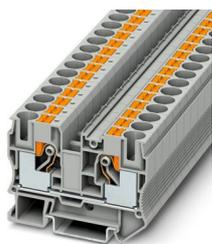
Blocs de jonction simple, tension nominale: 1000 V, intensité nominale: 57 A, nombre de connexions: 2, type de raccordement: Raccordement Push-in, Section de référence: 10 mm<sup>2</sup>, section : 0,5 mm<sup>2</sup> - 16 mm<sup>2</sup>, type de montage: NS 35/7,5, NS 35/15, coloris: gris
