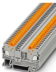
Blocs de jonction simple, tension nominale: 800 V, intensité nominale: 24 A, nombre de connexions: 2, type de raccordement: Raccordement rapide, 1er étage, Section de référence: 2,5 mm<sup>2</sup>, section : 0,5 mm<sup>2</sup> - 2,5 mm<sup>2</sup>, type de montage: NS 35/7,5, NS 35/15, coloris: gris
