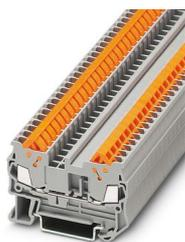
Blocs de jonction simple, tension nominale: 800 V, intensité nominale: 17,5 A, nombre de connexions: 2, type de raccordement: Raccordement rapide, 1er étage, Section de référence: 1,5 mm<sup>2</sup>, section : 0,25 mm<sup>2</sup> - 1,5 mm<sup>2</sup>, type de montage: NS 35/7,5, NS 35/15, coloris: gris
