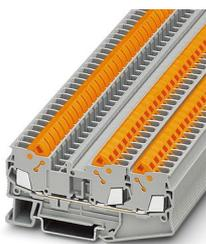
Blocs de jonction simple, tension nominale: 800 V, intensité nominale: 24 A, nombre de connexions: 3, type de raccordement: Raccordement rapide, 1er étage, Section de référence: 2,5 mm<sup>2</sup>, section : 0,5 mm<sup>2</sup> - 2,5 mm<sup>2</sup>, type de montage: NS 35/7,5, NS 35/7,5, coloris: gris
