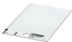
Repères pour blocs de jonction, Carte, blanc, vierge, repérable avec : BLUEMARK ID COLOR, BLUEMARK ID, THERMOMARK PRIME, THERMOMARK CARD 2.0, THERMOMARK CARD, type de montage: collage, surface utile: 104 x 3,8 mm, Nombre d'étiquettes: 22
