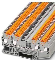
Blocs de jonction simple, tension nominale: 800 V, intensité nominale: 17,5 A, nombre de connexions: 4, type de raccordement: Raccordement rapide, 1er étage, Section de référence: 1,5 mm<sup>2</sup>, section : 0,25 mm<sup>2</sup> - 1,5 mm<sup>2</sup>, type de montage: NS 35/7,5, NS 35/7,5, coloris: gris
