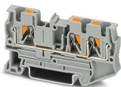
Blocs de jonction simple, tension nominale: 800 V, intensité nominale: 32 A, nombre de connexions: 3, type de raccordement: Raccordement Push-in, Section de référence: 4 mm<sup>2</sup>, section : 0,2 mm<sup>2</sup> - 6 mm<sup>2</sup>, type de montage: NS 35/7,5, NS 35/15, coloris: gris
