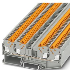
Blocs de jonction simple, tension nominale: 800 V, intensité nominale: 24 A, nombre de connexions: 4, type de raccordement: Raccordement rapide, 1er étage, Section de référence: 2,5 mm<sup>2</sup>, section : 0,5 mm<sup>2</sup> - 2,5 mm<sup>2</sup>, type de montage: NS 35/7,5, NS 35/7,5, coloris: gris
