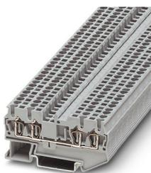
Blocs de jonction simple, tension nominale: 800 V, intensité nominale: 24 A, nombre de connexions: 4, type de raccordement: Raccordement à ressort, Section de référence: 2,5 mm<sup>2</sup>, section : 0,08 mm<sup>2</sup> - 4 mm<sup>2</sup>, type de montage: NS 35/7,5, NS 35/15, coloris: gris
