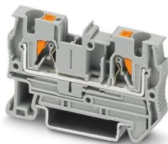
Blocs de jonction simple, tension nominale: 800 V, intensité nominale: 32 A, nombre de connexions: 2, type de raccordement: Raccordement Push-in, Section de référence: 4 mm<sup>2</sup>, section : 0,2 mm<sup>2</sup> - 6 mm<sup>2</sup>, type de montage: NS 35/7,5, NS 35/15, coloris: gris
