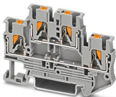
Bloc de jonction à deux étages, tension nominale: 500 V, intensité nominale: 22 A, type de raccordement: Raccordement Push-in, 1er et 2e étage, Section de référence: 2,5 mm<sup>2</sup>, section : 0,14 mm<sup>2</sup> - 4 mm<sup>2</sup>, type de montage: NS 35/7,5, NS 35/15, coloris: gris
