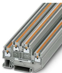
Bloc de jonction à deux étages, tension nominale: 500 V, intensité nominale: 16 A, type de raccordement: Raccordement Push-in, 1er et 2e étage, Section de référence: 1,5 mm<sup>2</sup>, section : 0,14 mm<sup>2</sup> - 1,5 mm<sup>2</sup>, type de montage: NS 35/7,5, NS 35/15, coloris: gris
