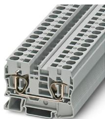
Blocs de jonction simple, tension nominale: 1000 V, intensité nominale: 57 A, nombre de connexions: 2, type de raccordement: Raccordement à ressort, Section de référence: 10 mm<sup>2</sup>, section : 0,2 mm<sup>2</sup> - 16 mm<sup>2</sup>, type de montage: NS 35/7,5, NS 35/15, coloris: gris
