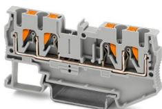
Blocs de jonction simple, tension nominale: 800 V, intensité nominale: 24 A, nombre de connexions: 4, type de raccordement: Raccordement Push-in, Section de référence: 2,5 mm<sup>2</sup>, section : 0,14 mm<sup>2</sup> - 4 mm<sup>2</sup>, type de montage: NS 35/7,5, NS 35/15, coloris: gris
