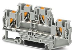
Bloc de jonction à deux étages, tension nominale: 500 V, intensité nominale: 28 A, type de raccordement: Raccordement Push-in, 1er et 2e étage, Section de référence: 4 mm<sup>2</sup>, section : 0,2 mm<sup>2</sup> - 6 mm<sup>2</sup>, type de montage: NS 35/7,5, NS 35/15, coloris: gris
