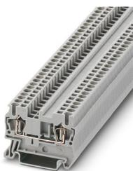
Blocs de jonction simple, tension nominale: 800 V, intensité nominale: 24 A, nombre de connexions: 2, type de raccordement: Raccordement à ressort, Section de référence: 2,5 mm<sup>2</sup>, section : 0,08 mm<sup>2</sup> - 4 mm<sup>2</sup>, type de montage: NS 35/7,5, NS 35/15, coloris: gris
