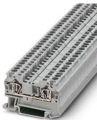
Blocs de jonction simple, tension nominale: 800 V, intensité nominale: 32 A, nombre de connexions: 2, type de raccordement: Raccordement à ressort, 1er étage, Section de référence: 4 mm<sup>2</sup>, section : 0,08 mm<sup>2</sup> - 6 mm<sup>2</sup>, type de montage: NS 35/7,5, NS 35/15, coloris: gris
