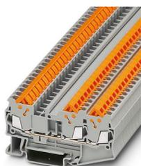
Blocs de jonction simple, tension nominale: 800 V, intensité nominale: 17,5 A, nombre de connexions: 3, type de raccordement: Raccordement rapide, 1er étage, Section de référence: 1,5 mm<sup>2</sup>, section : 0,25 mm<sup>2</sup> - 1,5 mm<sup>2</sup>, type de montage: NS 35/7,5, NS 35/7,5, coloris: gris
