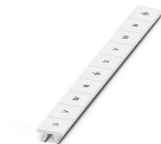
Repères pour blocs de jonction, Rubans, blanc, repéré, repérable avec : CMS-P1-PLOTTER, longitudinal: U, V, W, N, GND, U, V, W, N, GND, type de montage: encliquetage, pour bloc de jonction au pas de : 10,2 mm, surface utile: 10,15 x 10,5 mm, Nombre d'étiquettes: 10
