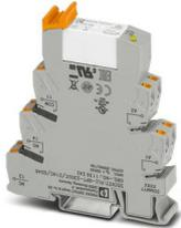
PLC-INTERFACE contre les courants perturbateurs ou les tensions perturbatrices côté commande. Comprenant un bloc de jonction de base à raccordement Push-in et un relais miniature enfichable à contact de puissance jusqu'à 10 A, 1 contact inverseur, tension d'entrée 230 V AC
