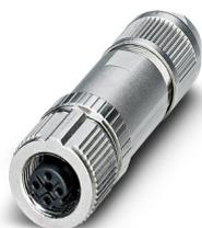
Connecteur, PROFINET CAT5 (100 Mbit/s), 4-pôles, blindé, connecteur femelle droit M12, D, Raccordement à ressort Push-Lock, matériau de la molette: Zinc moulé sous pression, nickelé, diamètre extérieur du câble 4 mm ... 8 mm
