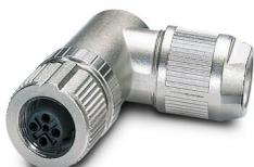
Connecteur, PROFINET CAT5 (100 Mbit/s), 4-pôles, blindé, connecteur femelle coudé M12, D, Raccordement à ressort Push-Lock, matériau de la molette: Zinc moulé sous pression, nickelé, diamètre extérieur du câble 4 mm ... 8 mm
