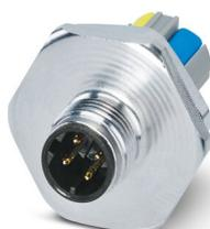
Traversée de paroi, PROFINET, 4-pôles, blindé, connecteur mâle droit M12, D, Montage sur face avant, M20 x 1,5, Raccordement à ressort Push-Lock, matériau de la molette: Laiton, nickelé, Écrou plat fourni
