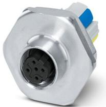
Traversée de paroi, PROFINET, 4-pôles, blindé, connecteur femelle droit M12, D, Montage sur face avant, M20 x 1,5, Raccordement à ressort Push-Lock, matériau de la molette: Laiton, nickelé, Écrou plat fourni
