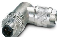
Connecteur, PROFINET CAT5 (100 Mbit/s), 4-pôles, blindé, connecteur mâle coudé M12, D, Raccordement à ressort Push-Lock, matériau de la molette: Zinc moulé sous pression, nickelé, diamètre extérieur du câble 4 mm ... 8 mm
