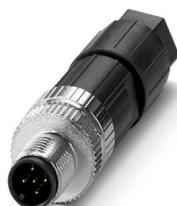
Connecteur, Universel, 5-pôles, non blindé, connecteur mâle droit M12, A, Raccordement à ressort Push-Lock, matériau de la molette: Zinc moulé sous pression, nickelé, diamètre extérieur du câble 4 mm ... 8 mm
