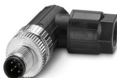
Connecteur, Universel, 5-pôles, non blindé, connecteur mâle coudé M12, A, Raccordement à ressort Push-Lock, matériau de la molette: Zinc moulé sous pression, nickelé, diamètre extérieur du câble 4 mm ... 8 mm
