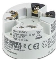
Ex i-Transmetteur de tête alimenté par la boucle de sortie pour la transmission des signaux de capteurs RTD et TC ainsi que de codeurs de résistance et de tension par 4 mA ... 20 mA. HART, Configuration standard, Raccordement vissé
