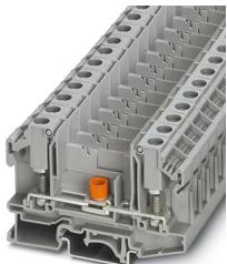
Bloc de jonction à fonction, tension nominale: 1000 V, intensité nominale: 41 A, type de raccordement: Raccordement boulonné, Section de référence: 6 mm<sup>2</sup>, section : 0,5 mm<sup>2</sup> - 6 mm<sup>2</sup>, montage: NS 35/7,5, NS 35/15, NS 32, coloris: gris
