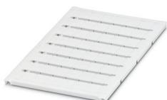
Repères pour blocs de jonction, à commander : sous forme de planche, blanc, impression selon les indications du client, type de montage: encliquetage dans la rainure de repérage élevée, pour bloc de jonction au pas de : 10,2 mm, surface utile: 9,6 x 10,5 mm, Nombre d'étiquettes: 48
