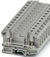
Blocs de jonction simple, avec vis à alvéole pour la réception des points test, tension nominale: 1000 V, intensité nominale: 41 A, type de raccordement: Raccordement boulonné, Section de référence: 6 mm<sup>2</sup>, section : 0,5 mm<sup>2</sup> - 6 mm<sup>2</sup>, type de montage: NS 35/7,5, NS 35/15, NS 32, coloris: gris
