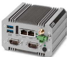
Box PC industriel (BPC) sans ventilateur, à indice de protection IP30 et processeur Intel® Celeron® N3350 à haut rendement énergétique, mémoire de masse eMMC de 32 Go, un emplacement ouvert M.2 et WLAN
