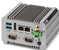
Box PC industriel (BPC) sans ventilateur, à indice de protection IP30 et processeur Intel® Celeron® N3350 à haut rendement énergétique, mémoire de masse eMMC de 32 Go, un emplacement ouvert M.2 et 2 ports COM
