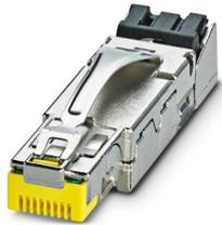
Connecteur RJ45, type: RJ45, indice de protection: IP20, nombre de pôles: 8, 10 Gbit/s, CAT6<sub>A</sub>, matériau: Métal, type de raccordement: Raccordement autodénudant, section raccordable: AWG 26- 24, sortie du câble: droit, coloris: jaune, Ethernet
