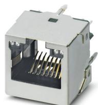
Connecteurs pour circuits imprimés RJ45, type: RJ45, indice de protection: IP20, nombre de pôles: 8, 10 Gbit/s, matériau: Métal, type de raccordement: Par refusion THR / à la vague THT
