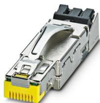
Connecteur RJ45, type: RJ45, indice de protection: IP20, nombre de pôles: 8, 10 Gbit/s, CAT6<sub>A</sub>, matériau: Métal, type de raccordement: Raccordement autodénudant, section raccordable: AWG 23- 22, sortie du câble: droit, coloris: jaune, Ethernet
