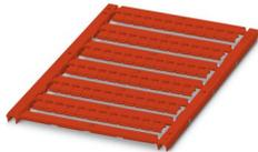
Repères pour blocs de jonction, Planche, rouge, vierge, repérable avec : TOPMARK NEO, LASER TOPMARK, BLUEMARK ID COLOR, BLUEMARK ID, BLUEMARK CLED, THERMOMARK PRIME, THERMOMARK CARD 2.0, THERMOMARK CARD, type de montage: encliquetage, pour bloc de jonction au pas de : 5,2 mm, surface utile: 4,4 x 4,7 mm, Nombre d'étiquettes: 72
