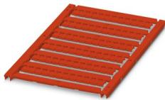
Repères pour blocs de jonction, Plaque, rouge, vierge, repérable avec : TOPMARK NEO, LASER TOPMARK, BLUEMARK ID COLOR, BLUEMARK ID, BLUEMARK CLED, THERMOMARK PRIME, THERMOMARK CARD 2.0, THERMOMARK CARD, type de montage: encliquetage, pour bloc de jonction au pas de : 5,2 mm, surface utile: 4,4 x 4,7 mm, Nombre d'étiquettes: 72
