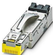
Connecteur RJ45, type: RJ45, indice de protection: IP20, nombre de pôles: 8, 10 Gbit/s, CAT6<sub>A</sub>, matériau: Métal, type de raccordement: Raccordement autodénudant, section raccordable: AWG 26- 24, sortie du câble: droit, coloris: jaune, Ethernet
