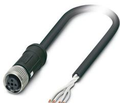
Câble pour capteurs/actionneurs, 4-pôles exempt d'halogène, extrémité libre, sur Connecteur femelle droit M12, détrompage: A SPEEDCONNEC, longueur de câble: 10 m, pour application ferroviaires
