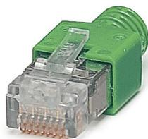
Connecteur RJ45, type: RJ45, indice de protection: IP20, nombre de pôles: 8, 1 Gbit/s, CAT5 (CEI 11801:2002), matériau: Plastique, type de raccordement: Raccordement à sertir, section raccordable: AWG 26- 24, sortie du câble: droit, coloris: vert, Ethernet
