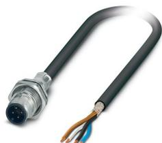
Connecteur d'appareil face arrière, 4-pôles, PUR, gris-noir RAL 7021, Connecteur mâle, droit, M12-SPEEDCONNEC, détrompage: A, sur extrémité libre, Montage face arrière, M16 x 1,5, Cordons individuels, longueur de câble: 6,5 m, 0,34 mm<sup>2</sup>, PUR exempt d'halogène noir
