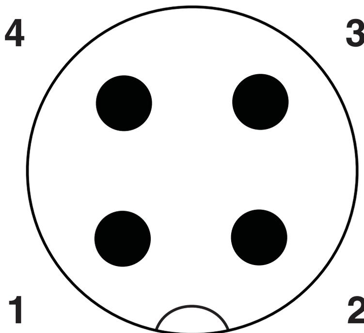
Brochage connecteur mâle M12, 4 pôles, détrompage A, vue côté connecteur mâle
