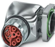
M23, Embases paroi avant, série: SH, coudé rotatif, blindé: oui, Pour verrouillage standard et SPEEDCON, Nombre de pôles: 4+4+PE / 3+N+PE, Sens de rotation: standard, type de contact: Connecteur femelle, Raccordement à sertir, Joint torique axial, 4x Ø 3,2, cote de bride: 26 mm x 26 mm, détrompage: N
