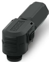
Connecteur, Famille d'articles: BPC, coloris: noir, nombre de pôles: 1, section de fil min.: 50 mm<sup>2</sup>, section de fil max.: 70 mm<sup>2</sup>, tension de référence: 1500, courant de référence: 250 A, Type de raccordement: Sertissage, Type de contact: Connecteur femelle, diamètre de câble min.: 11,3 mm, diamètre de câble max.: 17 mm
