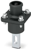
Connecteur, Famille d'articles: BPC, coloris: noir, nombre de pôles: 1, section de fil min.: 35 mm<sup>2</sup>, section de fil max.: 70 mm<sup>2</sup>, tension de référence: 1500, courant de référence: 250 A, Type de raccordement: vissée/soudée, Type de contact: Mâle
