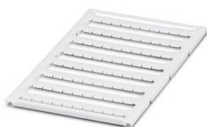
Repères pour blocs de jonction, Plaque, blanc, vierge, repérable avec : BLUEMARK ID COLOR, BLUEMARK ID, BLUEMARK CLED, PLOTMARK, CMS-P1-PLOTTER, type de montage: encliquetage, pour bloc de jonction au pas de : 6,2 mm, surface utile: 5,6 x 5,1 mm, Nombre d'étiquettes: 80
