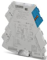
Ex i-Amplificateurs-séparateurs NAMUR pour détecteurs de proximité et commutateurs en zone ATEX. Les signaux sont transmis par 2 sorties de transistor (passives) dans la zone sécurisée. Configuration standard, Détection de défaut de ligne, Safety Integrity Level (SIL, IEC 61508): 3, Raccordement Push-in
