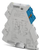
Ex i-Amplificateurs-séparateurs NAMUR pour détecteurs de proximité et commutateurs. Les signaux sont transmis par 1 relais Solid-State à la sortie (passive) au niveau de commande. Configuration standard, Détection de défaut de ligne, Safety Integrity Level (SIL, IEC 61508): 3, Raccordement vissé
