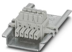
Connecteur-bus sur profilé (TBUS), 5 pôles, pour le pontage de la tension d'alimentation, encliquetable sur profilé NS 35/... selon EN 60715
