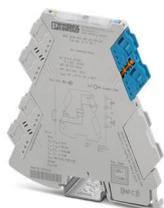
Ex i-Bloc de commande de vanne pour le pilotage d'électrovannes à sécurité intrinsèque dans une zone ATEX. tension en circuit ouvert: 20 V DC, limitation de courant: 25 mA, Configuration standard, auto-alimenté, Safety Integrity Level (SIL, IEC 61508): 3, Raccordement vissé
