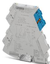
Ex i-Bloc de commande de vanne pour le pilotage d'électrovannes à sécurité intrinsèque dans une zone ATEX. tension en circuit ouvert: 16 V DC, limitation de courant: 50 mA, Configuration standard, auto-alimenté, Safety Integrity Level (SIL, IEC 61508): 3, Raccordement vissé
