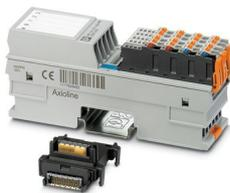
Axioline F, Module d'entrée numérique, Entrées TOR: 16, 24 V DC, connectique: 1 fil, Temps de filtre d'entrée <math>< 5 \mu\text{s}</math>, vitesse de transmission dans le bus local: 100 MBit/s, indice de protection: IP20, incl. module d'embase de bus et connecteurs Axioline F
