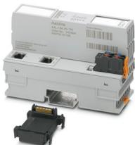
Axioline F, Coupleur de bus, PROFINET, Connecteur femelle RJ45, vitesse de transmission dans le bus local: 100 MBit/s, indice de protection: IP20, incl. module d'embase de bus et connecteur Axioline F
