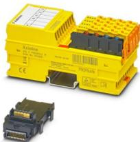
Axioline F, Module à relais, Sécurité fonctionnelle, PROFIsafe, destiné uniquement au raccordement sur des contrôleurs Phoenix Contact ou Siemens, Entrées de signalisation: 2, Sorties OUT24V\_0 et OUT24V\_1: 2, Sorties de relais sécurisées: 4 (indépendant du potentiel), Contact NO, indice de protection: IP20
