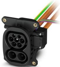
CHARX connect universal, Prise de raccordement côté véhicule, pour la recharge en courant alternatif (AC) et en courant continu (DC), CCS type 2, CEI 62196-2, CEI 62196-3, 200 A / 1000 V (DC), 32 A / 250 V (AC), Fils individuels, longueur: 2 m, actionneur de verrouillage: 12 V, 4 pôles, Montage sur les parois avant et arrière, M6, boîtiers: noir, Pour les contacts DC et AC, un cache de protection est fourni.
