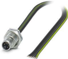
Connecteur d'appareil face arrière, Puissance, 6-pôles, Connecteur mâle, droit, M12, détrompage: M, Montage face arrière, M16 x 1,5, Cordons individuels, longueur de câble: 1,5 m, 1,31 mm<sup>2</sup>, Tresse de connexion UL/cUL, Produit de remplacement selon RoHS II sans exception 6c (Pb < 0,1 %) référence : 1238544
