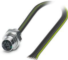
Connecteur d'appareil face arrière, Puissance, 6-pôles, connecteur femelle, droit, M12, détrompage: M, sur extrémité libre, Montage face arrière, M16 x 1,5, Cordons individuels, longueur de câble: 1,5 m, 1,31 mm<sup>2</sup>, Tresse de connexion UL/cUL, Produit de remplacement selon RoHS II sans exception 6c (Pb < 0,1 %) référence : 1238547
