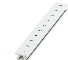
Ruban de repérage ZB, Rubans, blanc, repéré, repérable avec : CMS-P1-PLOTTER, type de montage: encliquetage, pour bloc de jonction au pas de : 8,3 mm, surface utile: 10,5 x 8,3 mm
