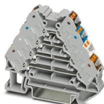
Connecteurs sous-répartiteurs, tension nominale: 250 V, intensité nominale: 10 A, type de raccordement: Raccordement Push-in, 1., 2., 3. und 4. Etage, Section de référence: 1,5 mm<sup>2</sup>, section : 0,14 mm<sup>2</sup> - 2,5 mm<sup>2</sup>, montage: NS 35/7,5, NS 35/15, coloris: gris, couleur des éléments de raccordement: multicolore
