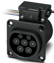
CHARX connect modular, Prise côté infrastructure, Rectangulaire, Premium, avec capteurs de température, avec LED (raccord de cathode commun), pour la charge en courant alternatif (AC) des véhicules électriques (VE), Type 2, CEI 62196-2, 32 A / 480 V (AC), sans fils individuels, actionneur de verrouillage: 12 V, 4 pôles, Montage sur la paroi arrière, Filetage M5, boîtiers: noir, Logo PHOENIX CONTACT
