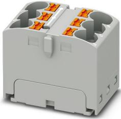
Bloc distributeur, Module de base, tension nominale: 450 V, intensité nominale: 32 A, nombre de connexions: 6, type de raccordement: Raccordement Push-in, section : 0,2 mm<sup>2</sup> - 6 mm<sup>2</sup>, type de montage: encliquetage sur l'adaptateur de profilé, Montage direct avec bride, Volant, coloris: gris
