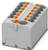
Bloc distributeur, Module de base avec alimentation, tension nominale: 450 V, intensité nominale: 32 A, nombre de connexions: 13, type de raccordement: Raccordement Push-in, Dérivation, section : 0,2 mm<sup>2</sup> - 6 mm<sup>2</sup>, Raccordement Push-in, Raccordement collectif, Section de référence: 10 mm<sup>2</sup>, section : 0,5 mm<sup>2</sup> - 10 mm<sup>2</sup>, type de montage: encliquetage sur l'adaptateur de profilé, Montage direct avec bride, Volant, coloris: gris
