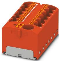
Bloc distributeur, tension nominale: 450 V, intensité nominale: 32 A, nombre de connexions: 13, type de raccordement: Raccordement Push-in, Dérivation, section : 0,2 mm<sup>2</sup> - 6 mm<sup>2</sup>, Raccordement Push-in, Raccordement collectif, Section de référence: 10 mm<sup>2</sup>, section : 0,5 mm<sup>2</sup> - 10 mm<sup>2</sup>, type de montage: encliquetage sur l'adaptateur de profilé, Montage direct avec bride, Volant, coloris: rouge
