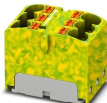
Bloc distributeur, pontage interne, tension nominale: 450 V, intensité nominale: 32 A, nombre de connexions: 6, type de raccordement: Raccordement Push-in, section : 0,2 mm<sup>2</sup> - 6 mm<sup>2</sup>, type de montage: encliquetage sur l'adaptateur de profilé, Montage direct avec bride, Volant, coloris: vert/jaune
