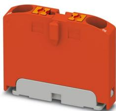
Bloc distributeur, Module de base, tension nominale: 450 V, intensité nominale: 24 A, nombre de connexions: 2, type de raccordement: Raccordement Push-in, section : 0,14 mm<sup>2</sup> - 4 mm<sup>2</sup>, type de montage: encliquetage sur l'adaptateur de profilé, Montage direct avec bride, Volant, coloris: rouge
