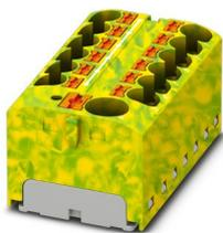
Bloc distributeur, pontage interne, tension nominale: 450 V, intensité nominale: 32 A, nombre de connexions: 13, type de raccordement: Raccordement Push-in, Dérivation, section : 0,2 mm<sup>2</sup> - 6 mm<sup>2</sup>, Raccordement Push-in, Raccordement collectif, Section de référence: 10 mm<sup>2</sup>, section : 0,5 mm<sup>2</sup> - 10 mm<sup>2</sup>, type de montage: encliquetage sur l'adaptateur de profilé, Montage direct avec bride, Volant, coloris: vert/jaune
