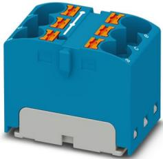
Bloc distributeur, pontage interne, tension nominale: 450 V, intensité nominale: 32 A, nombre de connexions: 6, type de raccordement: Raccordement Push-in, section : 0,2 mm<sup>2</sup> - 6 mm<sup>2</sup>, type de montage: encliquetage sur l'adaptateur de profilé, Montage direct avec bride, Volant, coloris: bleu
