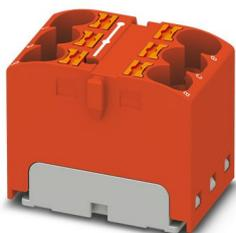
Bloc distributeur, pontage interne, tension nominale: 450 V, intensité nominale: 32 A, nombre de connexions: 6, type de raccordement: Raccordement Push-in, section : 0,2 mm<sup>2</sup> - 6 mm<sup>2</sup>, type de montage: encliquetage sur l'adaptateur de profilé, Montage direct avec bride, Volant, coloris: rouge
