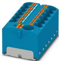
Bloc distributeur, tension nominale: 450 V, intensité nominale: 32 A, nombre de connexions: 13, type de raccordement: Raccordement Push-in, Dérivation, section : 0,2 mm<sup>2</sup> - 6 mm<sup>2</sup>, Raccordement Push-in, Raccordement collectif, Section de référence: 10 mm<sup>2</sup>, section : 0,5 mm<sup>2</sup> - 10 mm<sup>2</sup>, type de montage: encliquetage sur l'adaptateur de profilé, Montage direct avec bride, Volant, coloris: bleu
