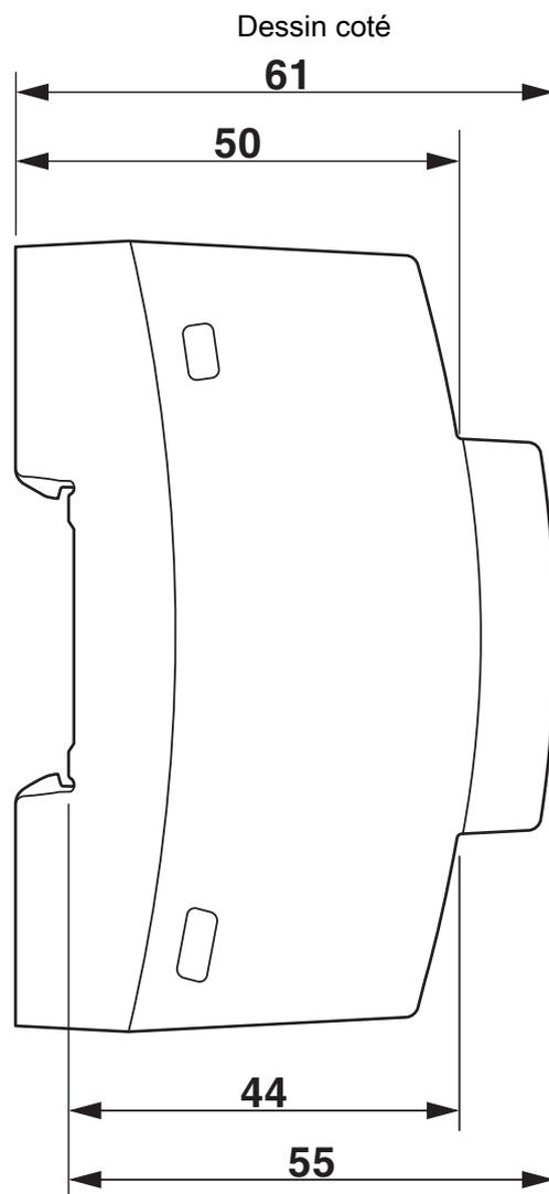
Encombrement de l'appareil (cotes en mm)
