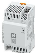
Alimentation à découpage primaire, STEP POWER, Raccordement Push-in, Montage sur rail DIN et montage direct, entrée: 1phasée, sortie : 15 V DC / 4 A, réglable de 9 V DC ... 17 V DC
