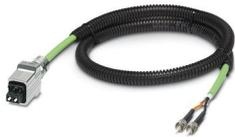
Câble fibre optique pré-équipé, câble PROFINET type B, fibre PCF 200/230  $\mu\text{m}$ , boîtier métallique Push-Pull SC-RJ/IP67 sur BFOC(ST)/IP20, gaine extérieure en PVC, sans halogène, résistant à l'ozone et aux UV, dans une gaine de protection, pour pose fixe à l'intérieur, longueur : 4,5 m
