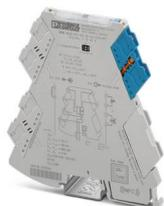
Ex i-Bloc de commande de vanne pour le pilotage d'électrovannes à sécurité intrinsèque dans une zone ATEX. tension en circuit ouvert: 16 V DC, limitation de courant: 50 mA, Configuration standard, Détection de défaut de ligne, Safety Integrity Level (SIL, IEC 61508): 3, Raccordement Push-in
