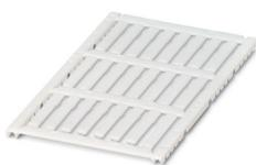
Repère pour crampon terminal, Planche, blanc, vierge, repérable avec : TOPMARK NEO, LASER TOPMARK, BLUEMARK ID COLOR, BLUEMARK ID, BLUEMARK CLED, THERMOMARK PRIME, THERMOMARK CARD 2.0, THERMOMARK CARD, type de montage: encliquetage, surface utile: 30 x 5 mm, Nombre d'étiquettes: 24
