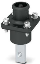
Connecteur, Famille d'articles: BPC, matériau du boîtier: PA, coloris: noir, nombre de pôles: 1, section de fil min.: 35 mm<sup>2</sup>, section de fil max.: 70 mm<sup>2</sup>, tension de référence: 1500, courant de référence: 250 A, Type de raccordement: vissée/soudée, Type de contact: Mâle
