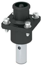
Connecteur, Famille d'articles: BPC, coloris: noir, nombre de pôles: 1, section de fil min.: 35 mm<sup>2</sup>, section de fil max.: 35 mm<sup>2</sup>, tension de référence: 1500, courant de référence: 160 A, Type de raccordement: Sertissage, Type de contact: Mâle
