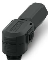
Connecteur, Famille d'articles: BPC, coloris: noir, nombre de pôles: 1, section de fil min.: 35 mm<sup>2</sup>, section de fil max.: 35 mm<sup>2</sup>, tension de référence: 1500, courant de référence: 160 A, Type de raccordement: Sertissage, Type de contact: Connecteur femelle, diamètre de câble min.: 9,7 mm, diamètre de câble max.: 12,3 mm
