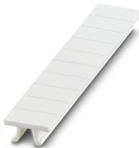
Ruban de repérage ZB, Rubans, blanc, vierge, repérable avec : PLOTMARK, CMS-P1-PLOTTER, type de montage: encliquetage, pour bloc de jonction au pas de : 5,2 mm, surface utile: 5,1 x 10,5 mm, Nombre d'étiquettes: 10
