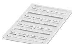
Repères pour blocs de jonction, Planche, blanc, vierge, repérable avec : BLUEMARK ID COLOR, BLUEMARK ID, BLUEMARK CLED, PLOTMARK, CMS-P1-PLOTTER, type de montage: encliquetage, pour bloc de jonction au pas de : 5,2 mm, surface utile: 4,6 x 5,1 mm, Nombre d'étiquettes: 96
