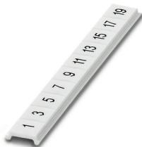
Ruban de repérage ZB, plat, Rubans, blanc, repéré, impression longitudinale: numérotation impaire 1-19, 21-39, etc. jusqu'à 81-99, type de montage: encliquetage, pour bloc de jonction au pas de : 5 mm, surface utile: 5,15 x 5,15 mm, Nombre d'étiquettes: 10
