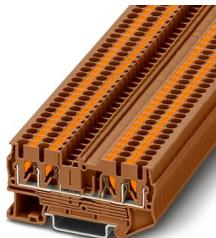
Blocs de jonction simple, tension nominale: 800 V, intensité nominale: 24 A, nombre de connexions: 4, type de raccordement: Raccordement Push-in, Section de référence: 2,5 mm<sup>2</sup>, section : 0,14 mm<sup>2</sup> - 4 mm<sup>2</sup>, type de montage: NS 35/7,5, NS 35/15, coloris: marron
