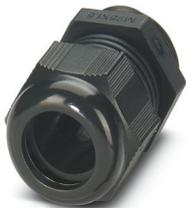
Presse-étoupe, matériau du raccordement vissé: PA, diamètre extérieur du câble 10 mm ... 14 mm, blindage: non, filetage de raccordement: M20 x 1,5, coloris: noir foncé RAL 9005
