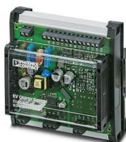
L'automate de charge EV-CC-AC1-M3-CBC-SER-HS avec boîtier pour le montage sur profilé, sert à la recharge des véhicules électriques sur le réseau à courant alternatif triphasé selon la norme CEI 61851-1, Mode 3. Optimisé pour les stations de recharge avec un connecteur de charge pour véhicule, monté en fixe. Toutes les fonctions de recharge et de vastes réglages de configuration sont déjà intégrés.
