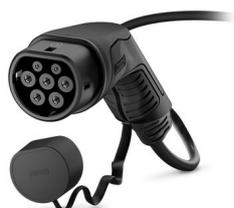
CHARX connect comfort, Câble de charge AC, avec connecteur de charge côté véhicule et extrémité de câble libre, pour charger en courant alternatif (AC) des véhicules électriques (EV) à prise côté véhicule de type 2, avec cache de protection, Type 2, CEI 62196-2, 20 A / 480 V (AC), câble: 4 m, noir, droit
