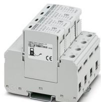
CHARX protect advanced : paratonnerre / parafoudre enfichable, conforme à type 1/2 / classe II / I, pour réseaux électriques triphasés avec conducteurs de neutre et de terre séparés (système à 5 conducteurs : L1, L2, L3, N, PE). Conçu spécialement pour une utilisation dans l'électromobilité.
