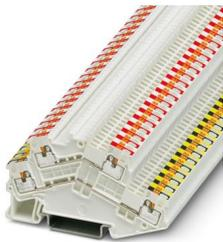
Bloc de jonction à deux étages, pour Bus KNX dans l'installation électrique du bâtiment, conditionné par deux (25 paires = 50 pièces), tension nominale: 500 V, intensité nominale: 16 A, type de raccordement: Raccordement Push-in, 1er et 2e étage, Section de référence: 1,5 mm<sup>2</sup>, section : 0,14 mm<sup>2</sup> - 1,5 mm<sup>2</sup>, type de montage: NS 35/7,5, NS 35/15, coloris: blanc
