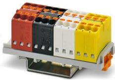
Bloc distributeur, pour bus KNX dans l'installation de bâtiment, bloc individuel avec pontage interne, coloris en fonction du codage de câble EIB, agencement Inline, tension nominale: 500 V, intensité nominale: 17,5 A, nombre de connexions: 24, type de raccordement: Raccordement Push-in, section : 0,14 mm<sup>2</sup> - 2,5 mm<sup>2</sup>, type de montage: NS 15, NS 35/7,5, NS 35/15
